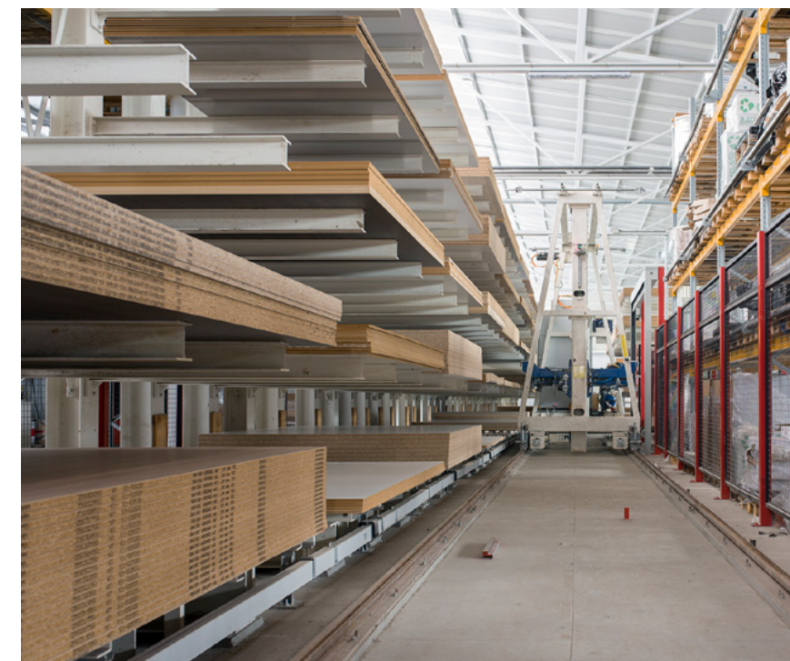
Almacenamiento automatizado para tableros.
