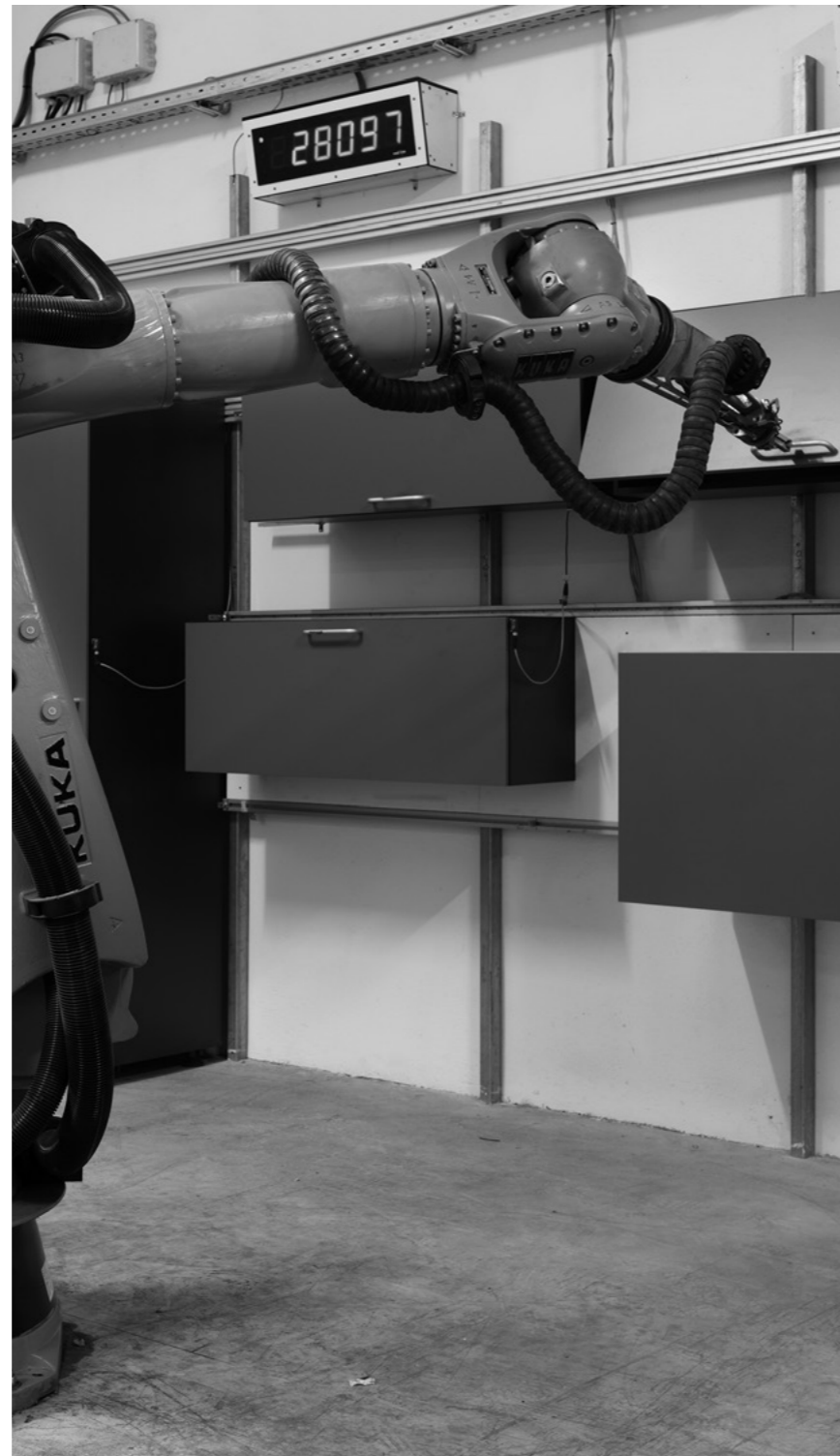
Test robotisé des cycles d'ouverture et de fermeture.
