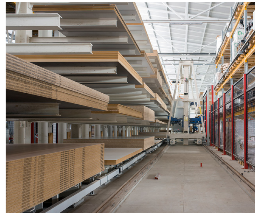
Stockage automatisé pour les panneaux.
