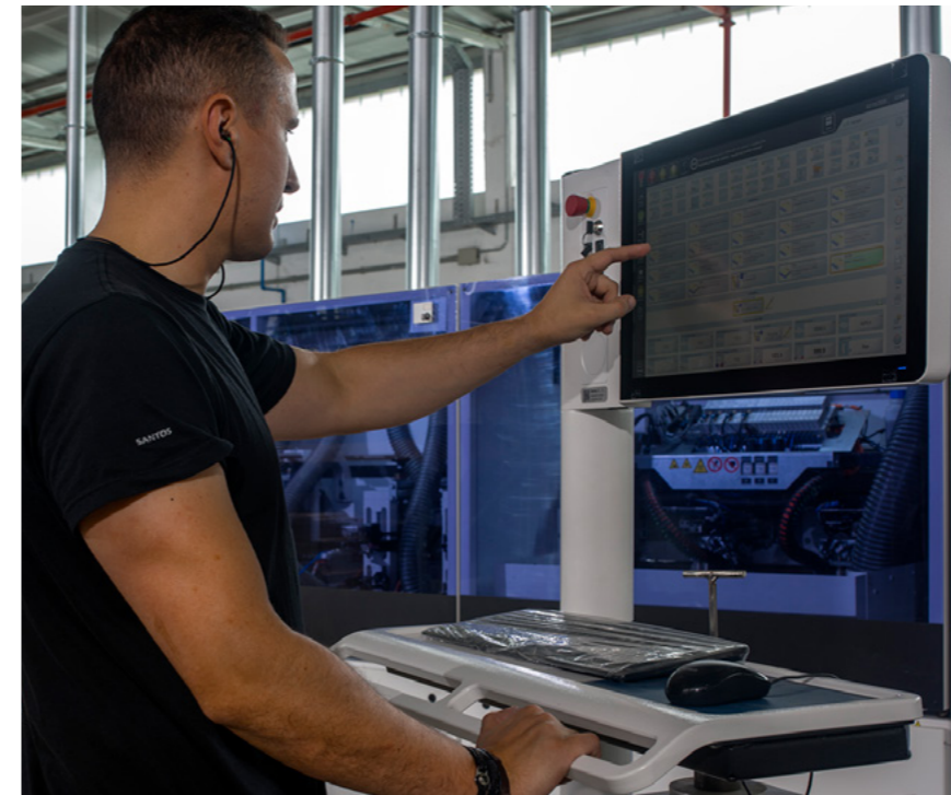
Quadros táteis de controlo e informação.
