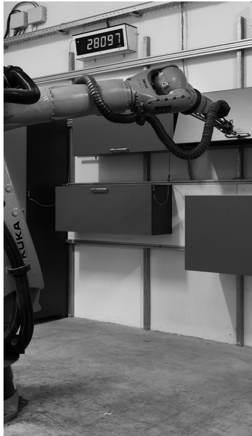
Ensaio robotizado de ciclos de abertura e fecho.
