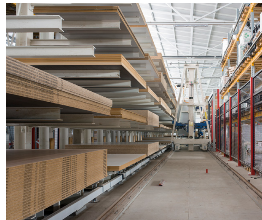
Almacenamiento automatizado para tableros.
