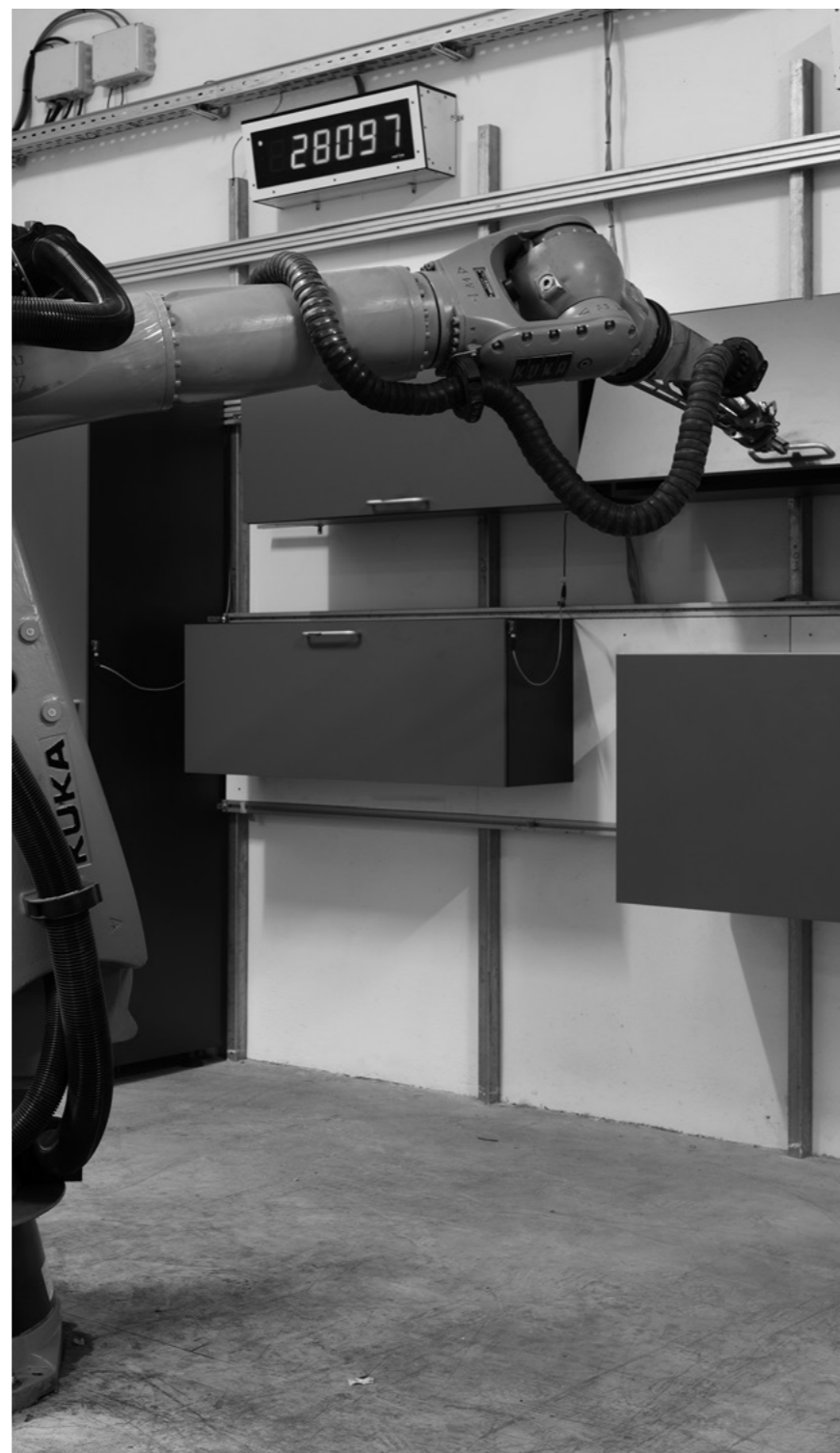
Ensayo robotizado de ciclos de apertura y cierre.
